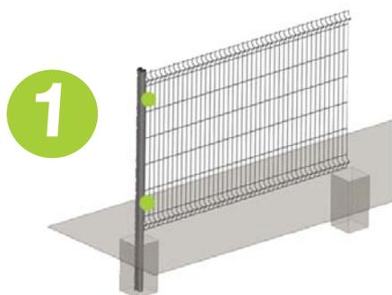
> Scellement du premier poteau. Accrochage du panneau dans les encoches du poteau et maintien du panneau en position verticale au moyen de deux pinces de montage (•).
