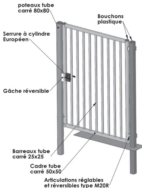
Possibilité d'inverser le sens d'ouverture en inversant le montage de la gâche sur le poteau et en inversant le sens de montage des plaques vissées sur le vantail.
