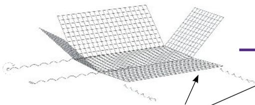
Placer 1 spirale par arête et les bloquer à l'aide d'une pince standard (non fournie dans le kit).
