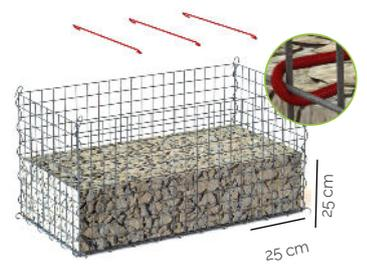
Placer les tirants de renfort tous les 25 cm de longueur et à 25 cm de hauteur, au niveau des croix de soudure et les refermer correctement avec une pince.
