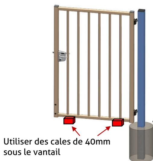
Utiliser des cales de 40mm sous le vantail
