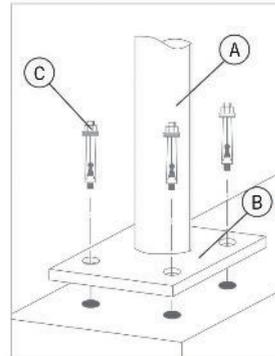
Possibilité d'incorporer une platine soudée pour fixer les poteaux sur un mur en béton et sur des clôtures de plus de 2m de hauteur.
