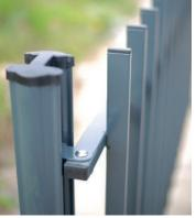
Grâce à la pièce de fixation spécialement conçue pour ce barreaudage, vous pouvez facilement réaliser des angles entre 90° et 180°. Afin de ne pas abîmer le barreaudage, il faut poser le poteau directement en angle et visser après. Ne pas visser avant puis essayer de tourner le poteau.
