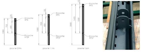
Mettre les poteaux à plat et placer les pièces de fixation (sans les fixer) dans les encoches. Dans le cas d'une pose linéaire sans redans, la première est à placer dans la 5ème encoche, quelle que soit la hauteur. La seconde se place soit à la 29ème, la 37ème ou la 57ème encoche, selon la hauteur de la clôture.
