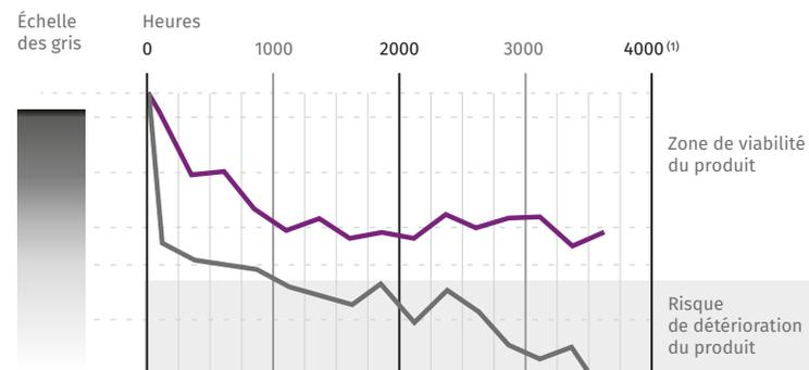
Test de vieillissement réalisé conformément à la Norme RAL GZ 716-1 (hygrométrie et UV).
