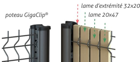
**4 /** Fixer les lames horizontales (avec traits de scie) à l'arrière du panneau en utilisant les vis préconisées (47 vis par pli) : vis pour bois avec tête fraisée et embout antifendage. Faire un avant-trou pour faciliter.
