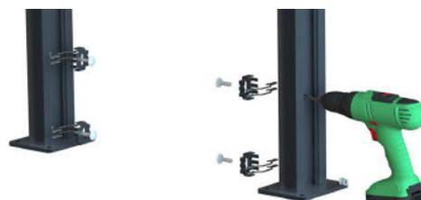
**3 /** Positionner la grille de finition basse et insérer les deux panneaux gabions dans les tirants de départ des griffes EVOMIX®.
