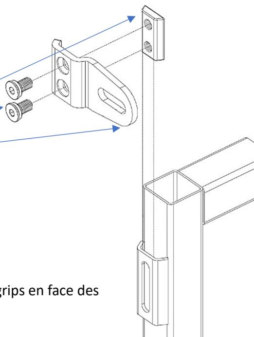
2. Poser le 1<sup>er</sup> vantail sur 2 cales de 40 / 50 mm, les grips en face des oreilles soudées sur le poteau.
