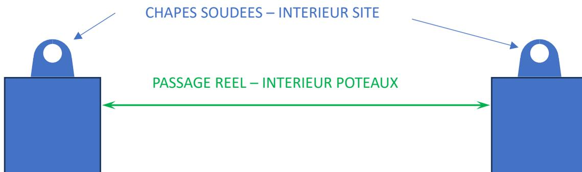
EXTERIEUR SITE – POSE STANDARD AVEC OUVERTURE VERS L'INTERIEUR
