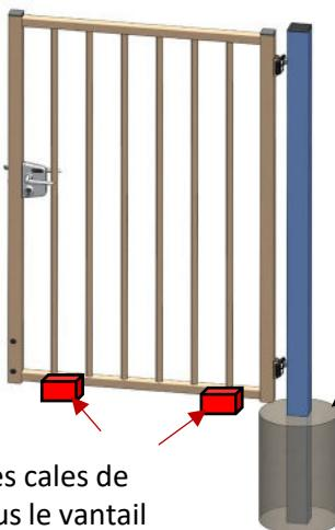
Respecter un écart de 60 mm entre le poteau et le vantail, en réglant les vis des gonds.
